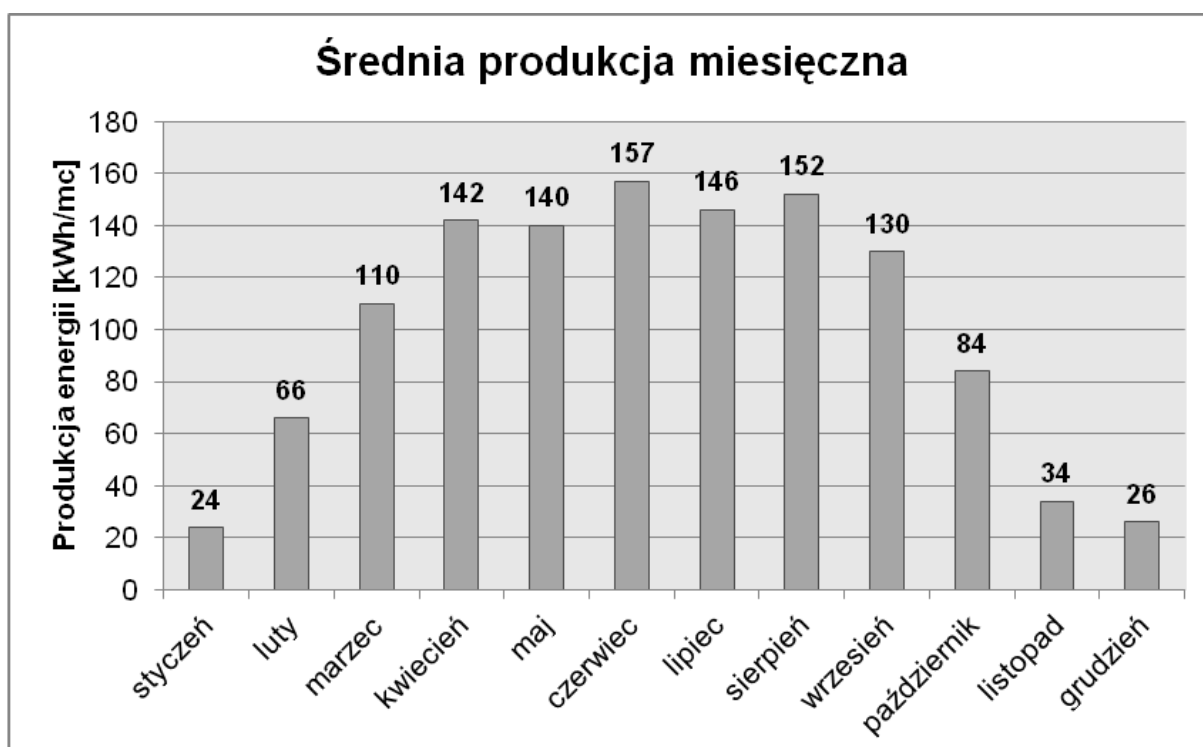
Wykres 13. Produkcja energii elektrycznej przez panele fotowoltaiczne
