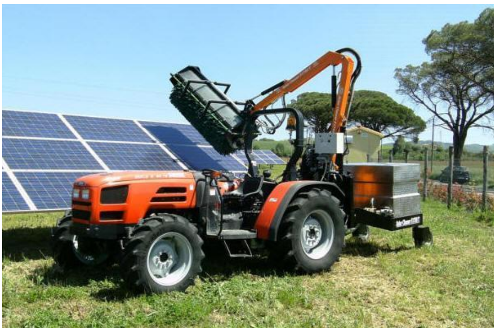
Ryc. nr 14 Maszyna do mycia paneli na farmach fotowoltaicznych Solar Cleaner F1750T
