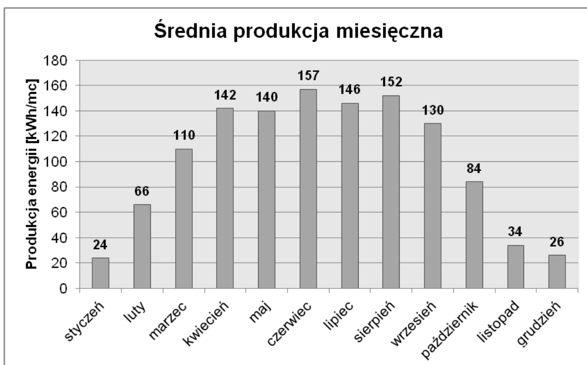
Wykres 13. Produkcja energii elektrycznej przez panele fotowoltaiczne
