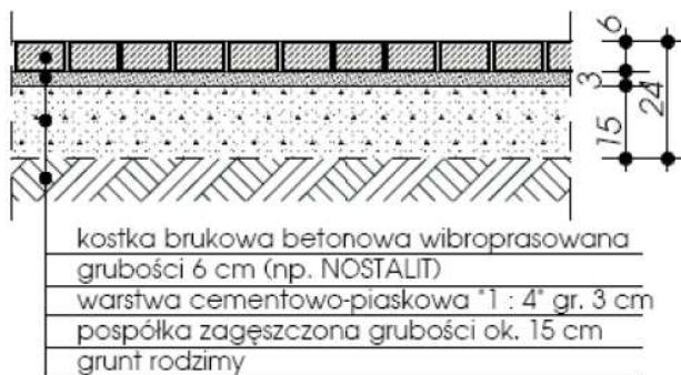
Rys.2 Sposób układania kostki brukowej
