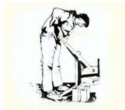
przy pomocy gilotyny do cięcia ściennych materiałów budowlanych
