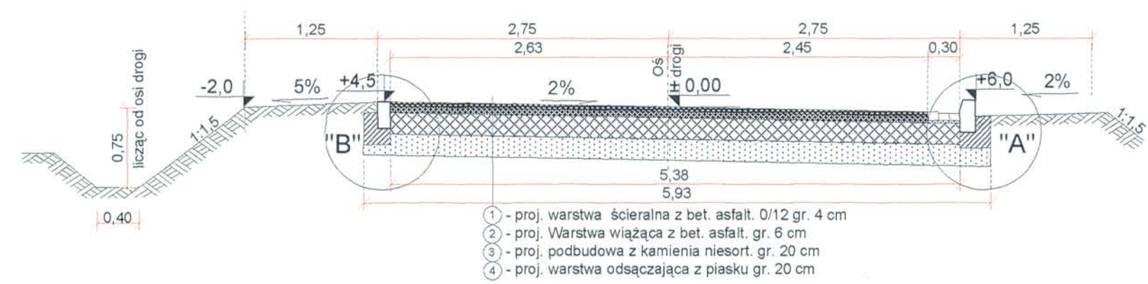
PRZEKRÓJ NORMALNY od km 0+007 do km 0+130 - skala 1:50
